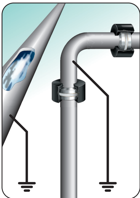
Slika 21: Primeri, ki prikazujejo preprečevanje razelektritve z iskro z ozemljitvijo vseh prevodnih delov in proizvodov (primerjaj s sliko 20).
