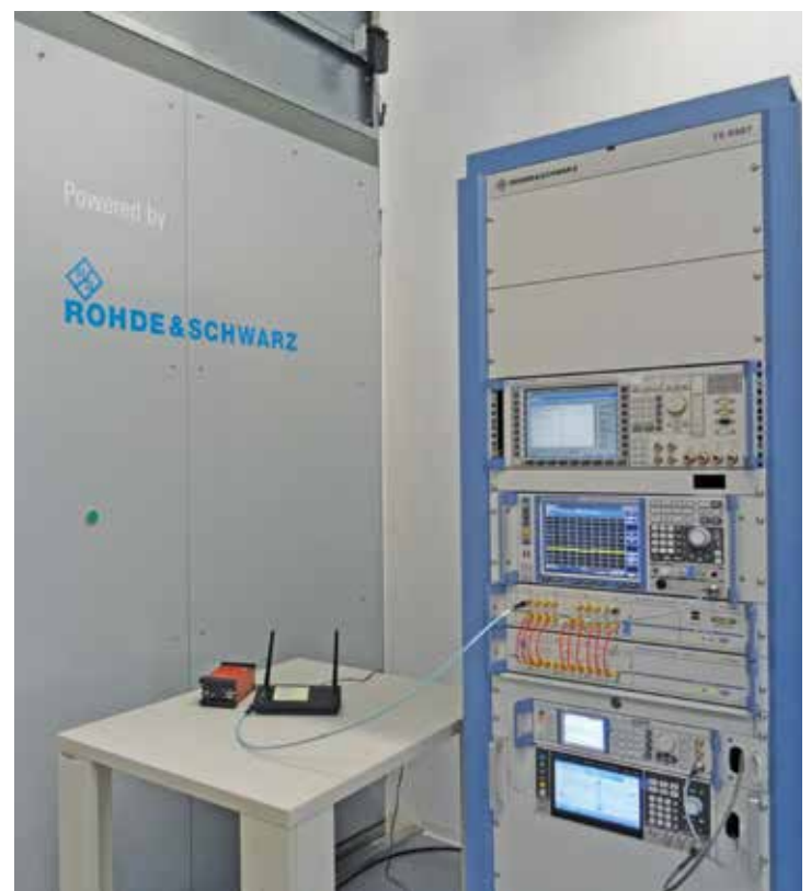
Merilni sistem R&S TS8997, ki omogoča preskušanje učinkovite rabe radijskega spektra.
