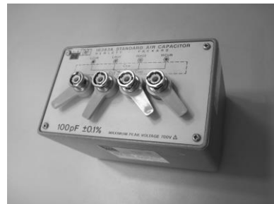
Slika 3: Štiri-terminalno oklopljen kondenzator iz kompleta HP 16380A
