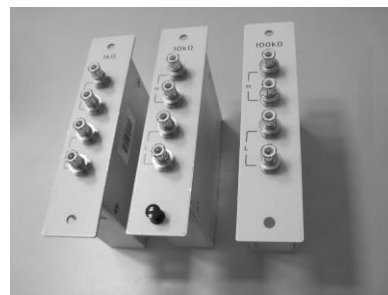
Slika 4: Štiri-terminalno oklopljeni upori iz kompleta HP 16074A
