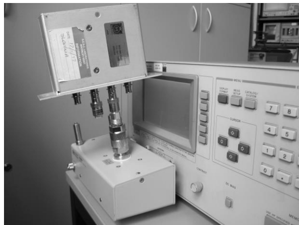
Slika 7: Merjenje parazitne kapacitivnosti upora C_{R1}
