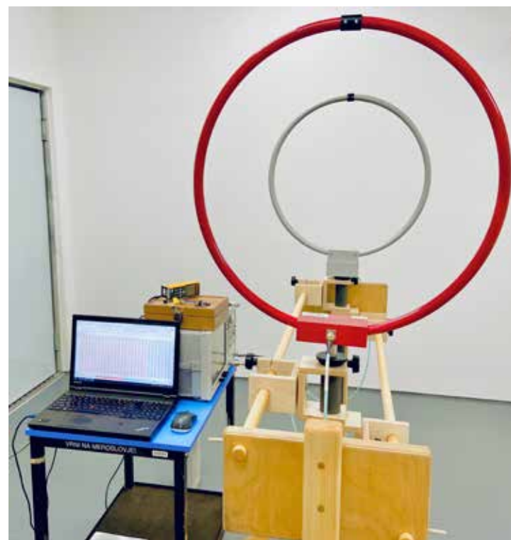
Merilna postavitve za kalibracijo loop anten.
