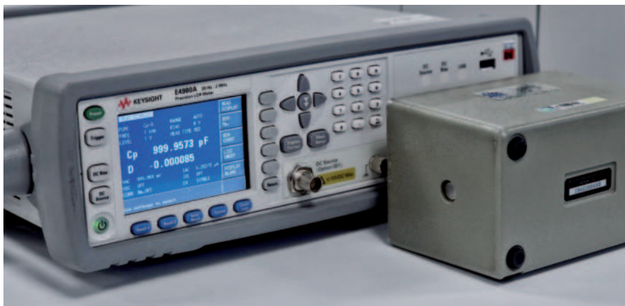
Kalibracija merilnika LCR z uporabo referenčnega kondenzatorja.
